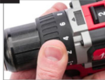
Si votre perceuse est munie d'un mode perceuse et embrayage, réglez-la sur le mode embrayage. Réglez votre perceuse à 30 % du couple maximum.
